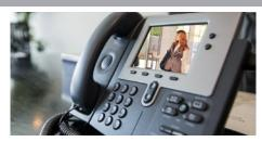
Über SIP (Session Initiation Protocol) wird auch die Einbindung in eine IP-Telefonanlage unterstützt. Wenn zum Beispiel die Türklingel mit einem kompatiblen Telefon verbunden ist, kann beim Klingeln das Livebild der Kamera auf dem Telefon eingeblendet werden.
